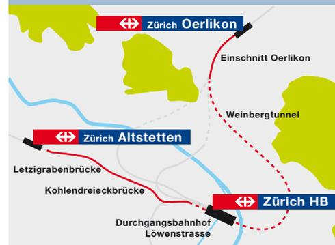
Die Durchmesserlinie durchquert ab 2013 als doppelspurige Linie die Stadt Zürich von Altstetten über Zürich HB bis nach Oerlikon. Das Herzstück der Durchmesserlinie ist der neue unterirdische Bahnhof Löwenstrasse.
