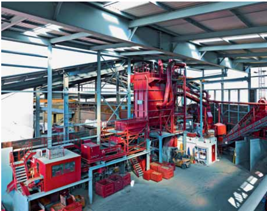
Der Schredder ist die erste Station der Rückgewinnung bei der Firma Bühlmann Recycling AG
