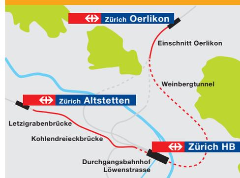
Die Durchmesserlinie durchquert ab 2014 als doppelspurige Linie die Stadt Zürich von Altstetten über Zürich HB bis nach Oerlikon. Das Herzstück der Durchmesserlinie ist der neue unterirdische Bahnhof Löwenstrasse.
